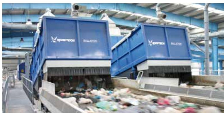
► **Fractia usoara (2D)**, formata din desuri usoare, plate, urca pe sitele balistice si se descarca prin partea de sus a acestora. Aceste materiale cu indice caloric mare pot intra in procesul urmator, de producere a combustibilului alternativ (RDF), sau, dupa caz, in procesul de sortare in vedera obtinerii de reciclabile.
